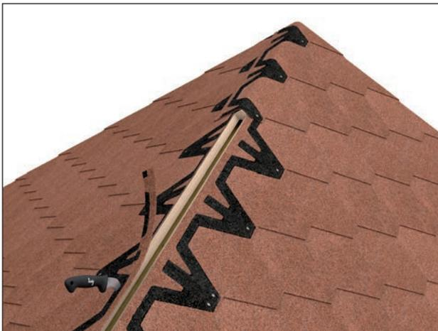
Ankommende und überstehende Schindel entsprechend abschneiden und befestigen. Die Deckung mit einzelnen Firststücken (33 cm x 33 cm) werden entgegen der Hauptwetterrichtung als seitliche Doppeldeckung verlegt. Die Befestigung erfolgt mit jeweils zwei Breitkopfstiften in der Überdeckung (ca. 16,5 cm).
