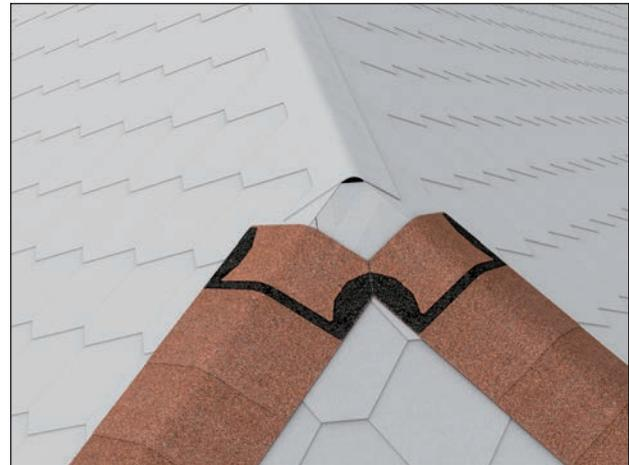
Die Grateindeckung erfolgt analog zu der Firsteindeckung. Bitumenschindeln der Fläche werden parallel zur Gratlinie zugeschnitten und die Schürzen mit einem wasserabweisenden Schrägschnitt versehen.
