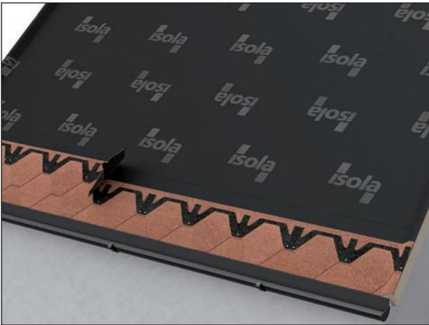
Schindeldeckungen werden immer im Versatz ausgeführt. Dazu wird das zweite und die folgenden Gebinde jeweils mit halben Schürzenversatz der Bitumenschindeln gedeckt und mit Breitkopfstiften 2,5 cm oberhalb der Schürzeneinschnitte befestigen. Die Unterkanten der Schürzen sind immer bündig mit den Oberkanten der Schürzeneinschnitte.
