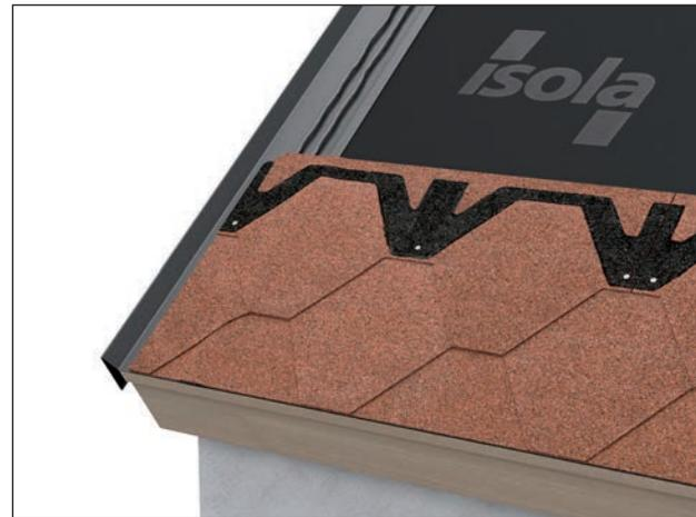
Das Ortgangprofil weist einen dachseitigen Wasserfalz und zur Außenseite eine Abtropfkante auf. Die Befestigung auf dem Dach erfolgt mit Haf-ten. Bitumenschindeln an der äußeren Oberkante mit wasserabweisenden Schrägschnitt versehen, ein Schrägschnitt an der Unterkante ist zu empfeh-len. Bitumenschindeln ca. 120 mm auf die Bleche führen. Es findet KEINE Befestigung, im Bereich des unterlegten Bleches statt, sondern die Schin-deln werden mittels Schindelkleber fixiert.
