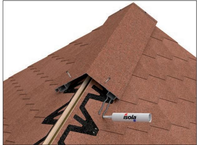
Ausgebaute und wärmedämmte Bitumenschindeldächer müssen grundsätzlich eine Be- und Entlüftung, sowie eine durchgehende Belüftung zwischen Schalung und Wärmedämmung aufweisen. Zur Entlüftung an First und Grat bietet sich der mit 200 cm<sup>2</sup> Lüftungsquerschnitt ausgestattete Isola Firstlüfter an. Alternativ kann die Entlüftung am First auch konstruktiv oder mit Flächenentlüfter hergestellt werden.
