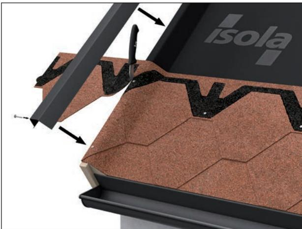
Bei dieser Ortgangvariante wird eine Holz-Dreikantleiste, mit einer Mindesthöhe von 30 mm montiert. Vordeckung und Schindeln werden entsprechend hochführt und mit Breitkopfstiften befestigen. Das Abdeckprofil muß entsprechend gekantet sein und zur Außenseite eine Abtropfkante aufweisen.
