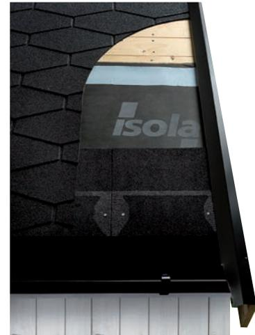
Untergrund sowie zur Schindel (im Sanierungsfall neu auf alt). Nur Bitumenbahnen bieten durch die Bitumenmasse eine zusätzliche Dichtigkeit am Nagelschaft hinsichtlich der späteren Befestigung der Schindel und stellen Sekundärwasserschutz sicher.
