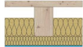
Wird der Gefachbereich auf volle Höhe mit Wärmedämmung ausgefüllt oder wird eine Aufdachdämmung zusätzlich verlegt, ist die Tragschalung mittels Konterlattung entsprechend aufzudoppeln.
