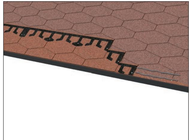
Bei der direkten Verlegung, Schindel auf Schindeln, achten Sie auf gleiche Gebindehöhen wie die ursprüngliche Deckung, um Abzeichnungen der Alteindeckung auf die neue Deckung zu vermeiden.
