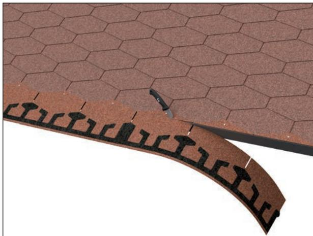
Damit keine Absenkung oder Abzeichnung der Neueindeckung zu befürchten ist, empfehlen wir das Ausfüllen der Schindellücken des alten Traufgebindes.
