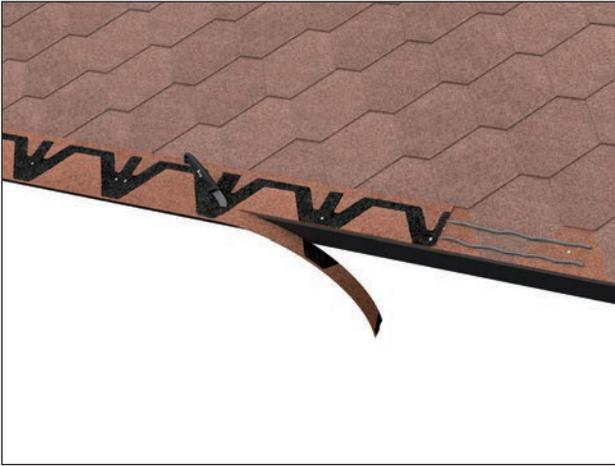
Prüfen Sie die Alteindeckung im Traufbereich auf festen Sitz. Nageln Sie diese ggf. nach, oder fixieren Sie in einem solchen Fall auch das neue Traufgebinde zusätzlich zur Verklebung.
