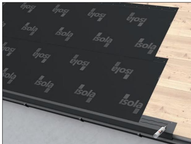
Als Vordeckung sind ausschließlich bituminöse Schalungsbahnen (z.B. Isola Schalungsbahn D oder Xtra) zu verwenden. Überdeckung der Nähte und Stöße mind. 8 cm. Quernähte sind zu versetzen. Befestigung in der Überdeckung im Abstand von ca. 10 cm mit Breitkopfstiften. Im Traufbereich wird die Vordeckbahn auf das Traufblech verlegt, endet aber ca. 3 cm vor der Abkantung. Auf dem Traufblech wird die Bahn zusätzlich mit Isola Schindelkleber fixiert.
