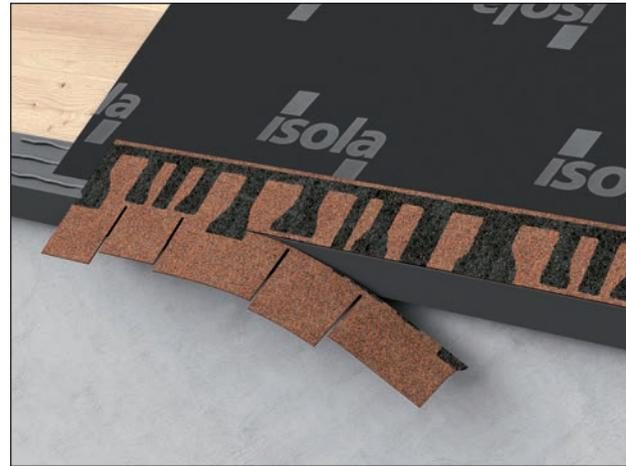
Schneiden Sie jetzt alle überstehenden Schindelschürzen bündig mit der Traufkante ab.
