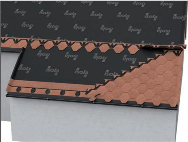
Bei Dachversprüngen oder Dachsleppen gehen Sie wie folgt vor: Maßgeblich ist die Haupttraufe, die auch in die Dachfläche hineinläuft. Schnüren Sie zuerst mittels Schnurschlaggerät das Traufgebinde der Haupttraufe fluchtgerecht über das gesamte Dach ab. Ggf. decken Sie diese Gebinde vor. Schnüren Sie die weiteren Gebinde mit dem konstanten Gebindemaß der jeweiligen zu verlegenden Schindelform in Richtung der zweiten Traufe ab.
